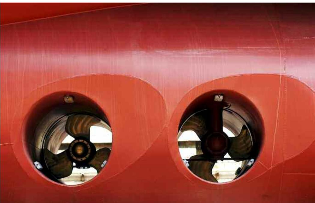
Avec le propulseur d'étrave, les deux propulseurs de poupe que l'on voit ici sont indispensables pour les manœuvres portuaires et le fonctionnement du système de positionnement dynamique.
