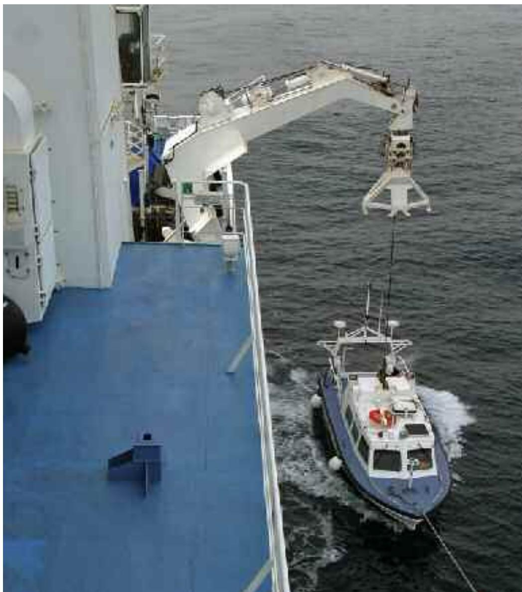
Précieuses auxiliaires du navire, notamment pour les levés de sondes, les deux vedettes du bord sont mises à l'eau par un seul homme au bossoir alors que l'équipage est déjà à bord et que le BHO poursuit sa route à petite vitesse.
